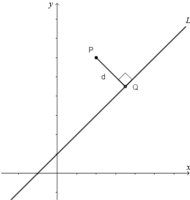
上圖中，有一點  $P$  與一直線  $L$ 。在  $L$  上取一點  $Q$ ，使得  $\overline{PQ} \perp L$ 。 $\overline{PQ}$  的長度  $d$  就是  $P$  點到直線  $L$  的距離。
