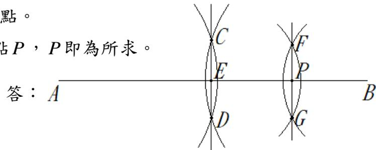
**練習五** 下圖為線段  $AB$ ，利用尺規在線段上找出一點  $P$ ，使得  $\overline{AP}:\overline{BP}=5:3$ 。
